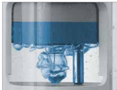
EasyClean 100的清洁操作。在传感器下方中心处形成水泡，可保证进行柔和清洁。
